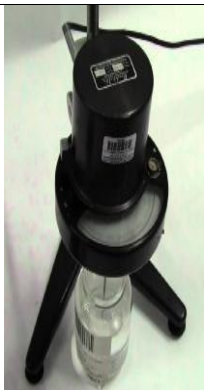
Вискозиметр Brookfield LVT с UL адаптером
